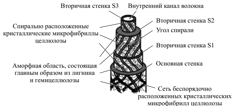
Рис. 1. Внутренняя структура типичной пряди натуральных волокон [23].
