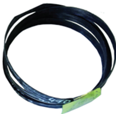
Рис. 1. Кольцевые образцы для испытаний на разрыв.
