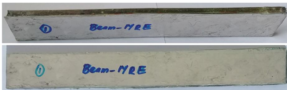
Рис. 3. Образец балки с МРЭ.
