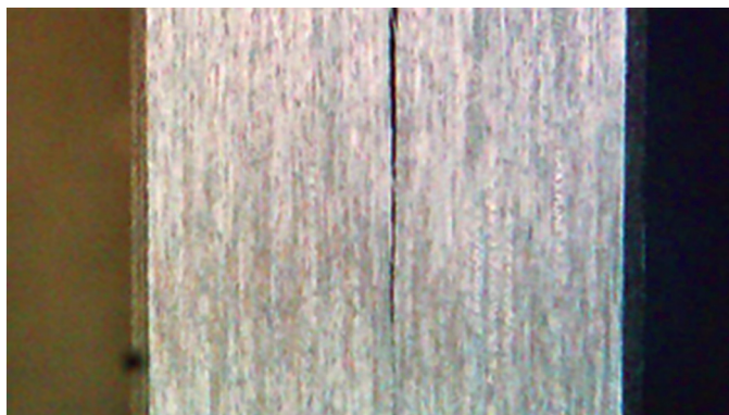
Рис. 7. Развитие трещины в модифицированном испытании на раскол клином.
